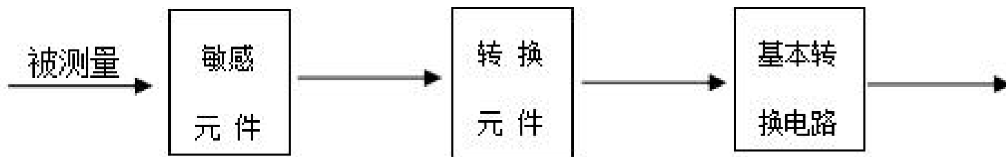
图 3.1.2 传感器基本结构示意图
