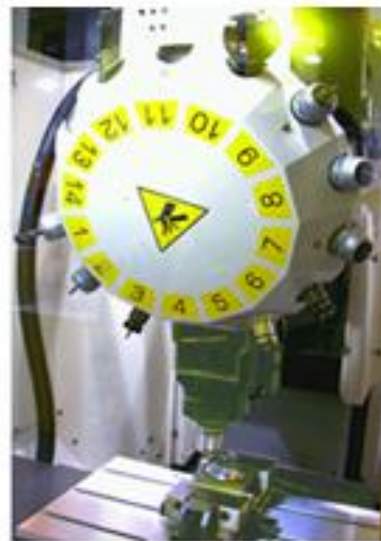
3.2.7 编码器用于刀库选刀控制图
